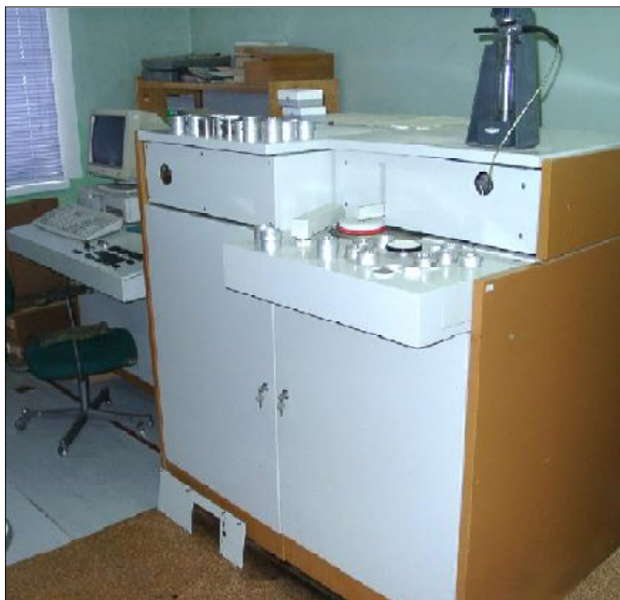
Рентгенофлуоресцентный сканирующий спектрометр VRA-33 производства фирмы «VEB Carl Zeiss Jena» (Германия).
